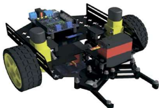
Мобильно-манипуляционная платформа КПМИС (стартовый)
